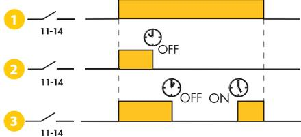
La desconexión/conexión programada del 12.81 permite tres diferente maneras de funcionar:
