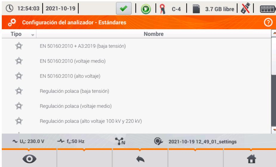
**Fig. 18. Ajustes del analizador - administrador de normas.**
