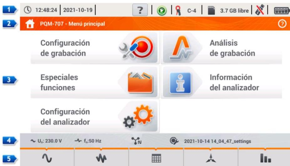
Fig. 2. Principales elementos de la pantalla del analizador.
