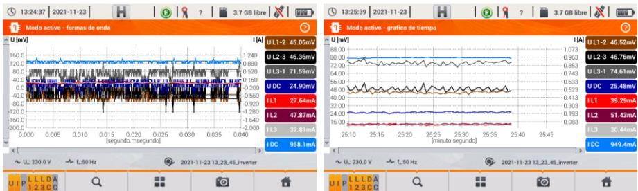
**Fig. 48** Pantallas de formas de onda y gráficos de tiempo en el modo de medición de la eficiencia del inversor.
