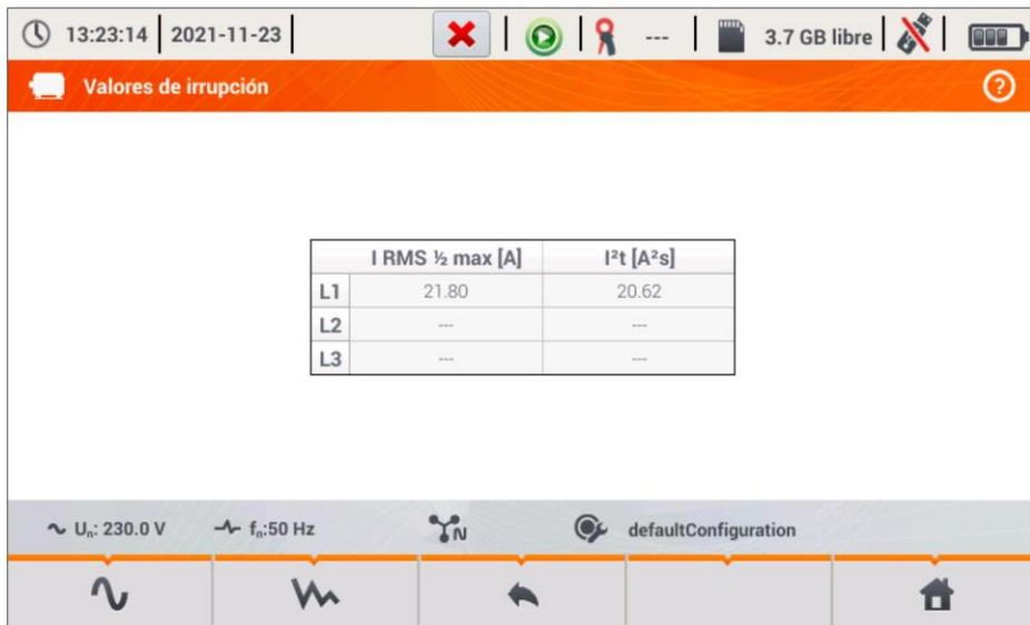
Fig. 44. Corriente de arranque - parámetros característicos.
