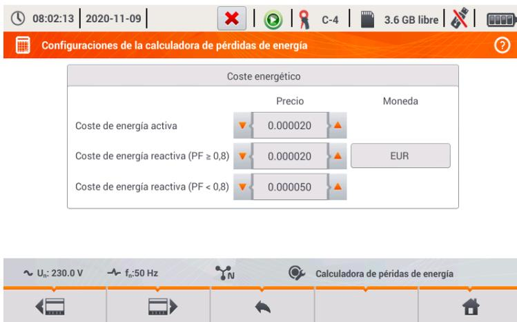
**Fig. 51 Análisis de las pérdidas de energía - pantalla de configuración 2**
