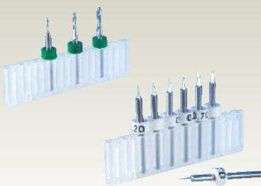
Las agujas de grabado se seleccionan según los medios donde se grabaran. Para el aluminio y otros medios de metal blando, se puede seleccionar el cortador de doble diente en varios anchos de punta. Para los medios de plástico, las agujas de grabado con un ángulo de 15° deben ser utilizados. Otras opciones de agujas de grabado están disponibles bajo pedido.
