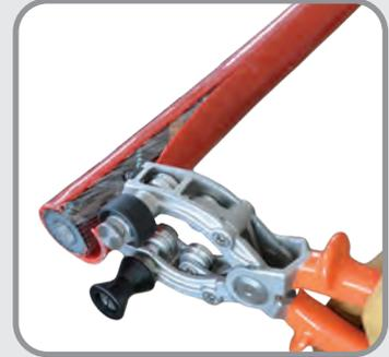
Extracción de la cubierta protectora
