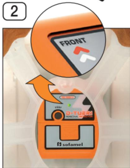
Accrocher le détecteur, au ruban Dual Lock en appuyant dessus jusqu'à sa fixation totale en orientant la flèche vers la partie avant du casque.
