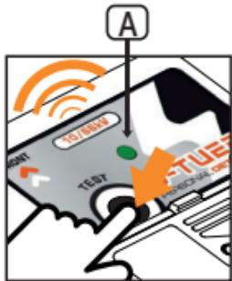
Appuyer sur le bouton de **TEST** et vérifier que le signal sonore **\*1** apparaisse et que le **LED VERT** **A** reste allumé.
