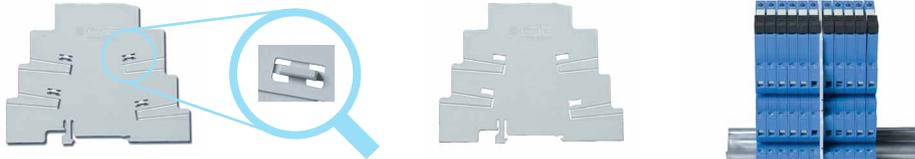
2. Manteniendo la pestañas en su lugar proporciona una separación de 6.2mm. Con un simple corte (con tijera) del segmento/segmentos pertinente, permite la interconexión a través del separador de 2 grupos diferentes de interfaces, utilizando los puentes estándar.
