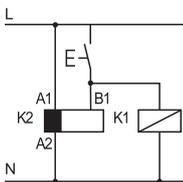
• Admite la Señal de mando (borne B1), así como el de una segunda carga: relé, telerrutor, etc..., con el mismo contacto.
