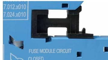
1. Con el módulo portafusibles insertado, después de quitar el tapón, el fusible se conecta eléctricamente en serie con el común del contacto de carga de la interfaz (borna 11 en las ejecuciones EMR, 13+ en las ejecuciones SSR, 15 en el temporizador EMR, 15+ en el temporizador SSR). Este estado se visualiza mediante el testigo/indicador.
