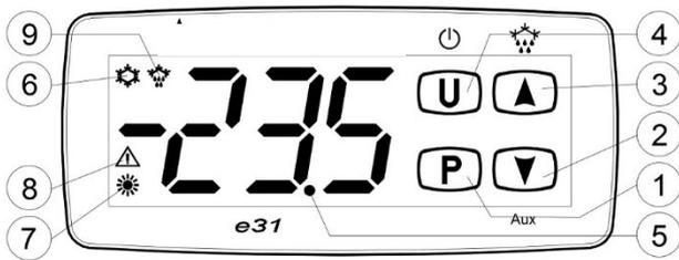
**1 - Tecla P:** Pulsando y soltando rápidamente se accede al cambio de Set Point.
