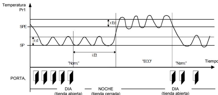
*Ejemplo de funcionamiento automático de la modalidad Eco y la modalidad normal. Durante el horario de trabajo, la puerta se suele abrir frecuentemente y el controlador funcionará en la modalidad normal. Transcurrido el tiempo "iEt" mientras la puerta no está abierta, el controlador cambia a la modalidad Eco. En cuanto se vuelve a abrir la puerta, el controlador vuelve a la modalidad normal.*
