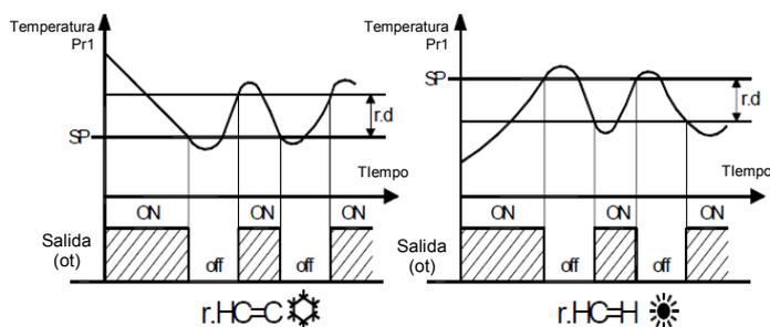
Relativamente al modo de funcionamiento programado en el parámetro “rHC”, el equipo automáticamente considera el diferencial con valor positivo para un control de Refrigeración (“rHC”=C) o con valor negativo para el control de Calentamiento (“rHC”=H).
