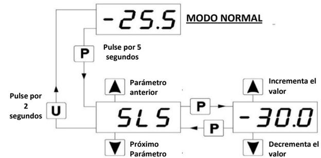
Para tener acceso a los parámetros de funcionamiento del equipo, cuando la protección de parámetros no está activa. Se debe pulsar la tecla P y mantenerla pulsada durante 5 segundos. Transcurrido ese tiempo el display visualizará el código que identifica el primer parámetro.
