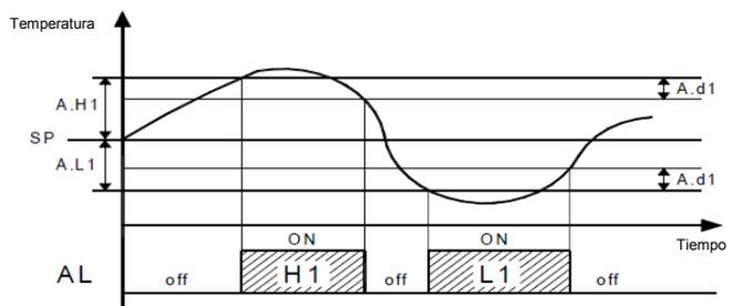
Las alarmas de temperatura máxima y de mínima se pueden desactivar programando los parámetros “**AHA**” y “**ALA**” = **oF**. Cuando actúan las alarmas de temperatura, el LED AL se enciende para señalar las alarmas y activa el buzzer interno, si está configurado.
