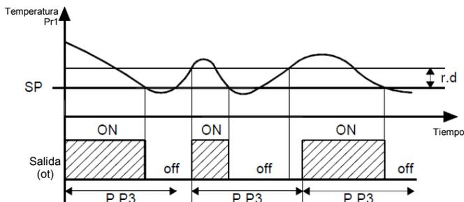
Si la protección está actuando, impidiendo la marcha del relé por el tiempo programado, el LED de la salida relé (Frio o Calor) se queda intermitente.
