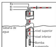
**4.2 – Función Reservorio**: El relé de salida energiza cuando se alcanza el nivel mínimo y desenergiza al alcanzar el nivel máximo. Aplicación: Evite el funcionamiento del equipo controlado cuando el líquido alcance el nivel superior (ej.: Una bomba que suministra un **reservorio de agua**).
