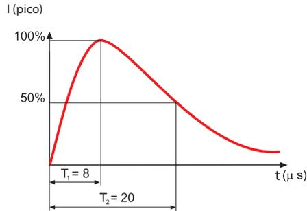
Figura 6: Forma de onda de corriente 8/20 μs
