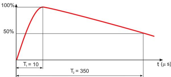
Figura 5: forma de onda de corriente 10/350 μs
