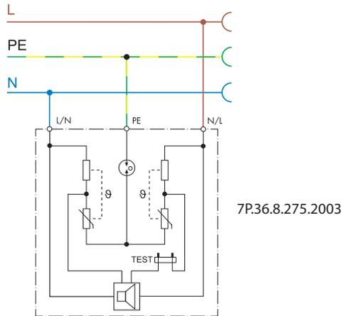
Ejemplos de esquemas de instalación para SPD de Tipo 1 + 2 y Tipo 2 - Trifásico
