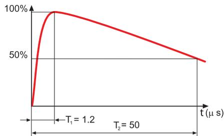
Figura 7: Forma de onda de corriente 1.2/50 μs
