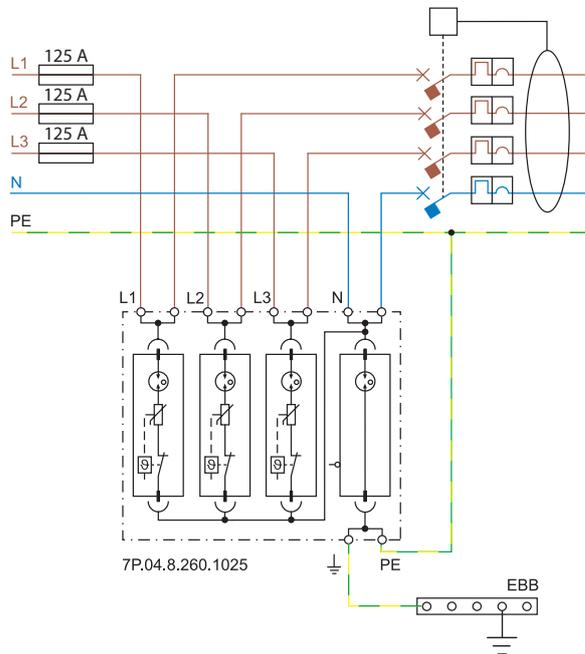
Para sistemas en los que la corriente nominal es mayor a 125 A, se debe proceder con la clásica instalación del SPD en paralelo al sistema (T-shape).
