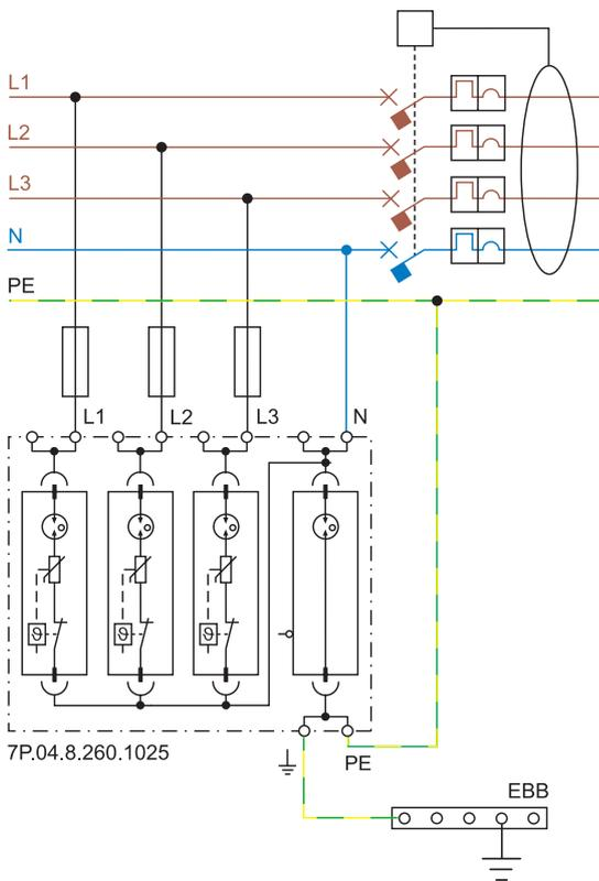
Esquema de enlace "V-shape" (fusible máx. = 125 A)
