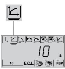
Figure 7.4: Start Ramp Time parameter displayed
