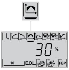
Figure 7.8: Initial/End voltage parameter displayed
