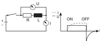
**Comutación de la bobina de un relé.**
