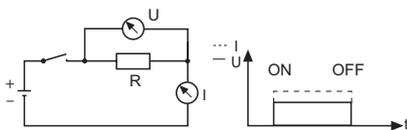
Característica tensión / corriente al conectar la bobina de un relé (carga inductiva) - (fig. 2).
