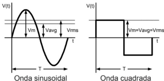
$V_m$ : valor máximo,  $V_{avg}$ : valor promedio,  $V_{rms}$ : RMS,  $T$ : período de tiempo
