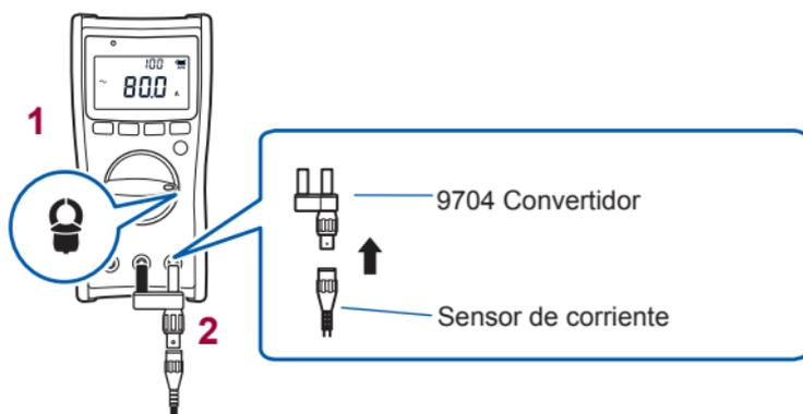
Coloque el sensor de corriente y el instrumento en el mismo rango.
