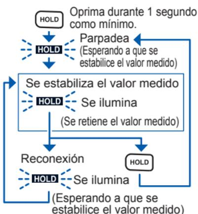
Oprima **HOLD** durante 1 segundo como mínimo. (**HOLD** parpadea: el instrumento está esperando a que se estabilice el valor medido).
