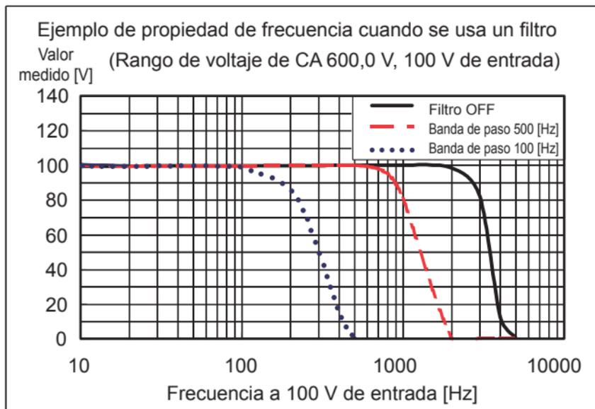
Ejemplo: La frecuencia de energía en una aeronave o embarcación es de 400 Hz
