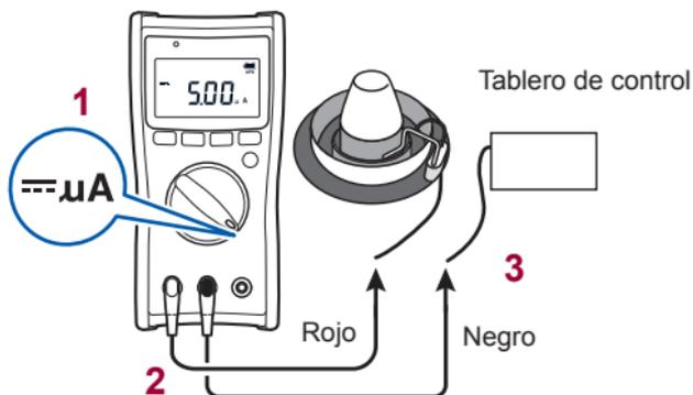
Ejemplo: Medir la corriente del encendedor ( $\mu\text{A}$ )
