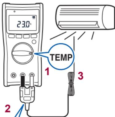
Cuando se detecta un termopar (K) abierto se muestra en pantalla
