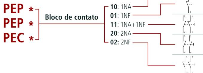
**Exemplo:** Pulsador de emergência giratório com bloco de comando 1NA+1NF.
