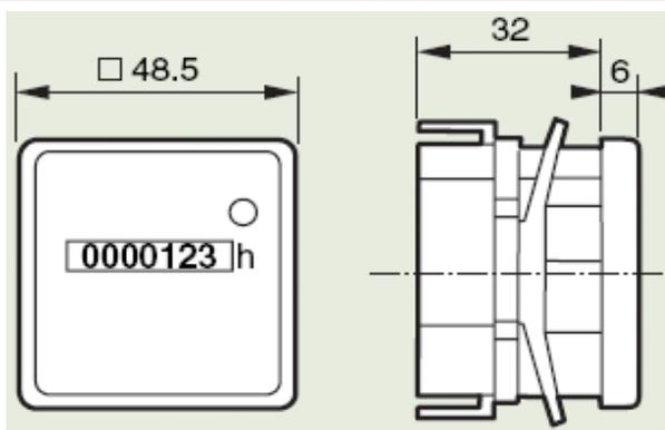
Permite conocer el tiempo de funcionamiento de una máquina y proceder al mantenimiento preventivo del mismo. Su funcionamiento es por motor síncrono. Su montaje se realiza sobre la puerta del tablero.
