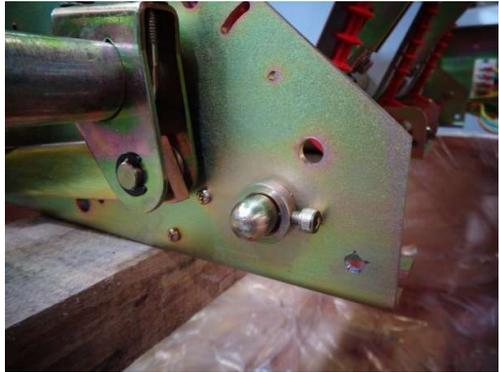
3.- Montar el soporte con los aisladores al seccionador, utilizar los accesorios 12, 13,14 y 15, el acabo es como muestra la imagen.
