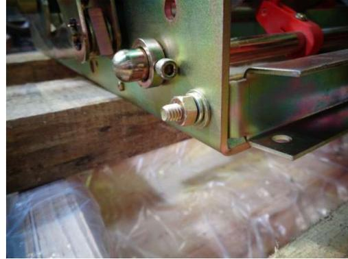
Los aisladores deben quedar distanciados del sistema de accionamiento de apertura con una separación de 10mm.
